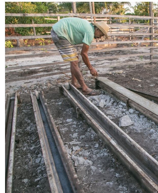
Produção de pilares de concreto. Fonte: Memorial Chico Mendes
